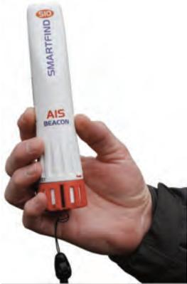
Der kleine Sender wird „am Mann“ getragen und im Notfall aktiviert. Nach dem Auslösen wird zunächst das AIS-Signal in Verbindung mit der GPS-Position ausgesendet,
