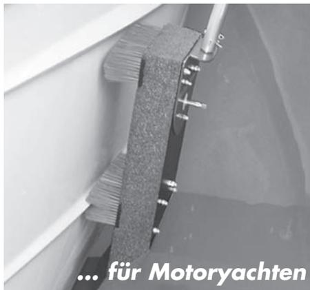
sich der Auftriebskörper an die Außenflächen des Bootes. Dort kann er seine reinigende Wirkung entfalten – großflächig, mit an jeder Stelle gleichmäßigem Andruck des Reinigungsvlieses. Dieser Auftriebsdruck bietet die Gewähr für ein gleichmäßiges Reinigungsergebnis – es ist nicht mehr die Muskelkraft des Skippers entscheidend.
